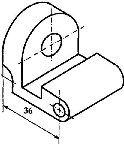
C2.- Acotar la pieza de la representación adjunta añadiendo a ésta los cortes o secciones que se consideren convenientes para su correcta definición y acotación.
